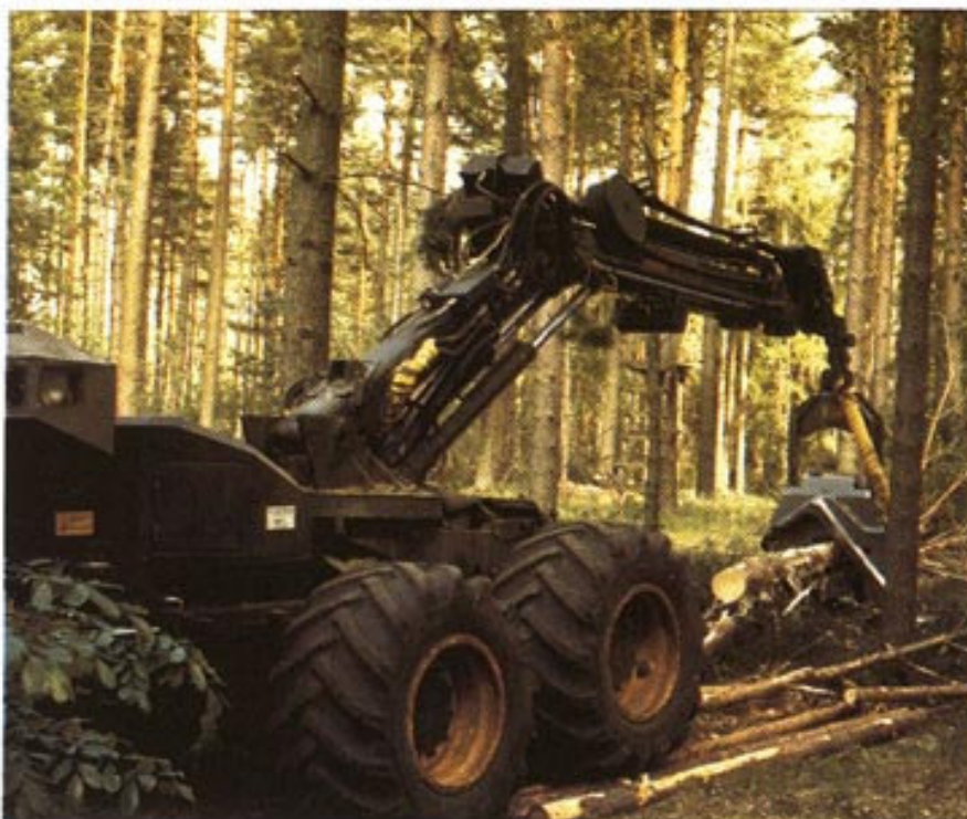
A fákat ún. harvesterekkel döntik és darabolják fel
